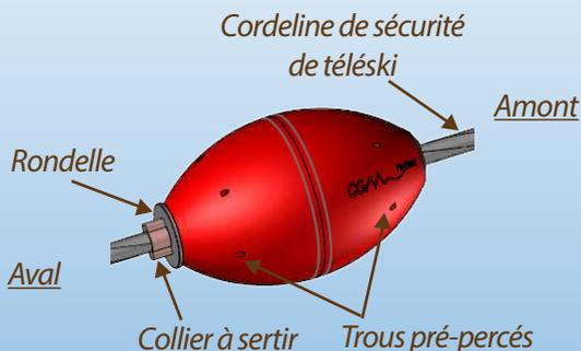
**Il est IMPERATIF de ne pas bloquer le flotteur en AMONT afin qu'il puisse conserver son mouvement de rotation.**
